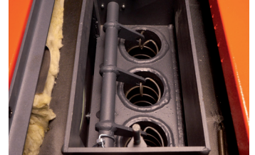
Abb. 6: Leitungen des Rohrbündelwärmetauschers mit Turbolatoren
