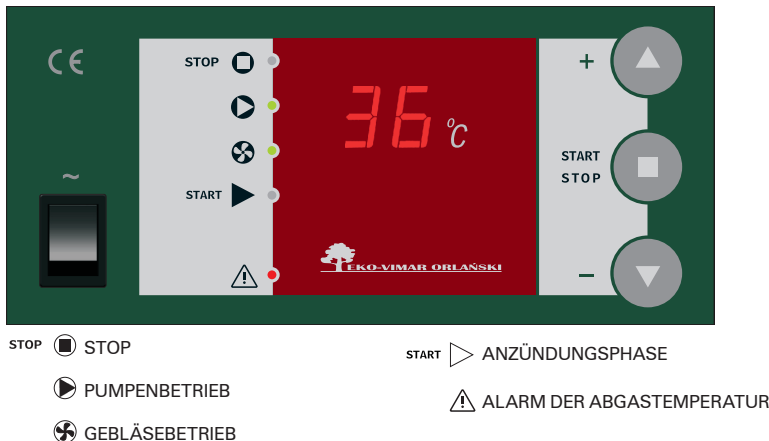
Bild 2. Beschreibung der Kontrolllampen des Reglers
