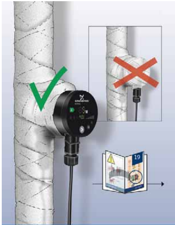
Abb. 5 Dämmen des Pumpengehäuses
