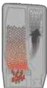
Schema des Rauchgas- übergangs durch den Kesselkörper
