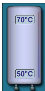
Pufferspeicher mit aktuellen Temperaturen oben und unten
