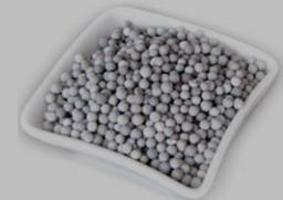
In den Kassetten befinden sich unterschiedliche Granulate als Schüttgut. Diese reagieren mit den Abgasen und neutralisieren die Schadstoffe. Der Einsatz von Schüttgut hat folgende Vorteile:
