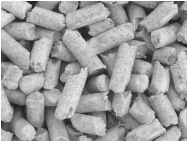
Hochwertige Holzpellets - weiße ohne schwarze Punkte (Rinde)
