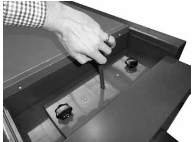
Beispiel der gewöhnlichen Reinigung des Rohraustauschers und der Bremsenlemente durch kurze An-Auf-Bewegungen
