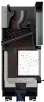
Abbildung 2. Die Luftzirkulationsübersicht in den Einsätzen der NBC-Serie.
