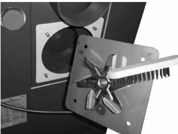
Muster – die Reinigung und die Kontrolle der Schaufel bei Saugzuventilator (außer PX10)
