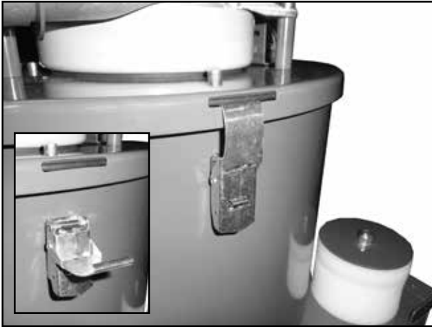
Deckelbefestigung des Abscheidebehälters
