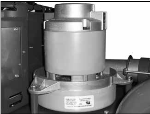
Motor des Sauglüfters der pneumatischen Förderanlage
