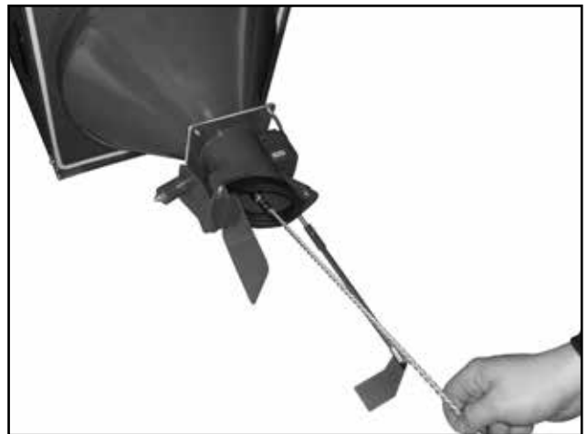
Bürsten des Siebs durch die Brennstoff-Ausschüttöffnung
