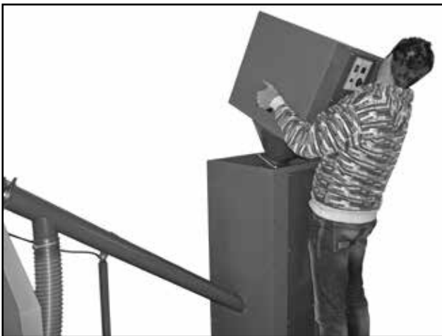
Abheben der pneumatischen Förderanlage vom Ausgleichbehälter
