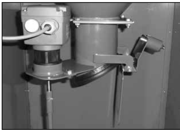
Klappe des Abscheidebehälters während der Entleerung – willkürlich durch Gewicht der Pellets geöffnet
