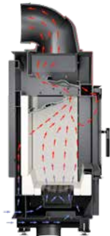
Rysunek 8. Schemat obiegu powietrza wewnątrz wkładów z serii LUCY. / The air circulation overview inside the inserts from the LUCY Series.
