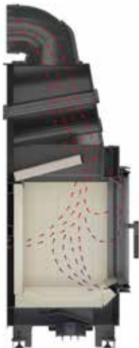
Rysunek 14. Schemat obiegu powietrza wewnątrz wkładów z serii MB. The air circulation overview inside the inserts from the MB Series.
