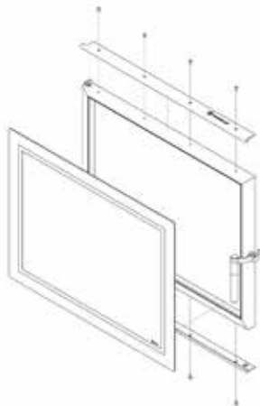
Rysunek 18. Demontaż i wymiana drzwi seria MB. / The MB series door disassembly and replacement.
