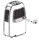
Schrauben Sie den Ablaufanschluss (im Lieferumfang enthalten) in den Anschlussnippel im Uhrzeigersinn ein.
