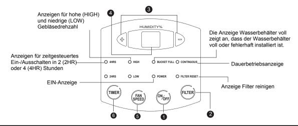
HINWEIS: Die Bedientasten funktionieren nicht, wenn der Wasserbehälter voll oder entfernt ist.
