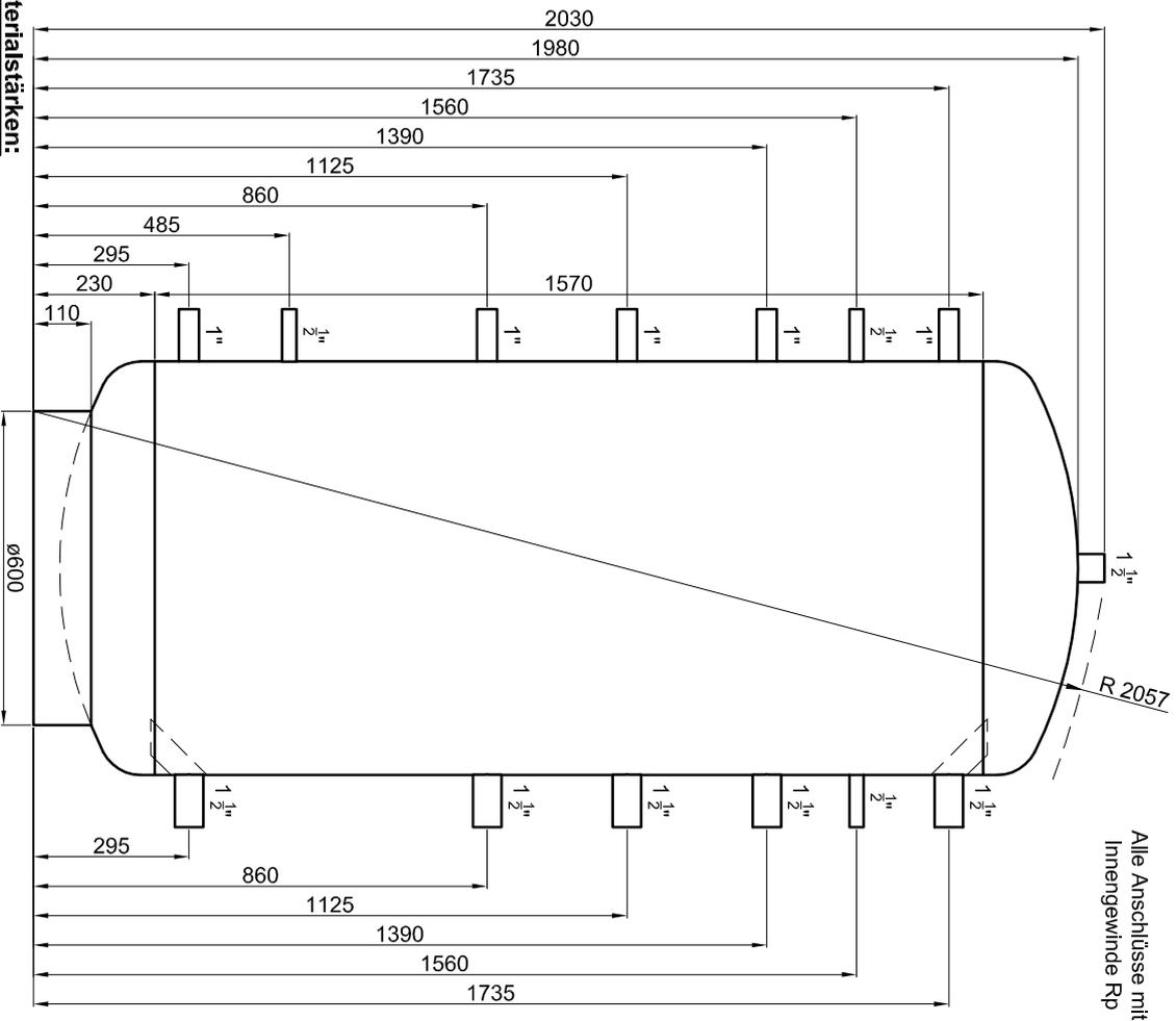
Alle Anschlüsse mit Innengewinde Rp
