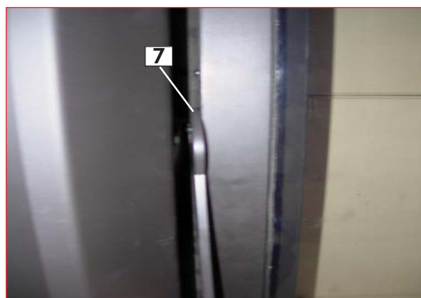
Figura 3 : bloccaggio portellone aperto (ruotare il nottolino di 90°)
