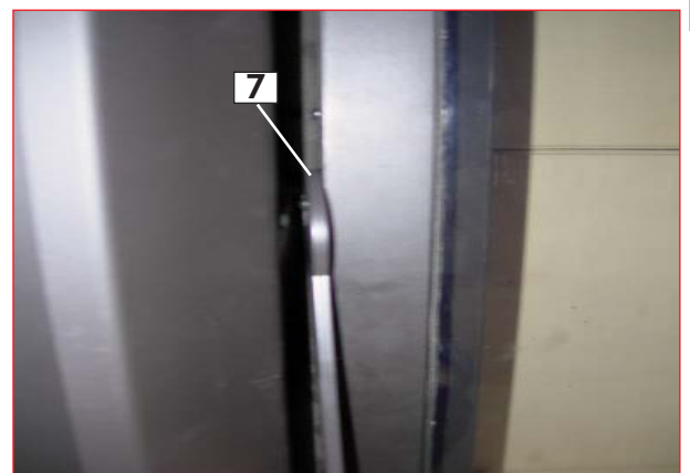
Abbildung 3: Geöffnete Türsperre (die Knagge um 90° drehen)
