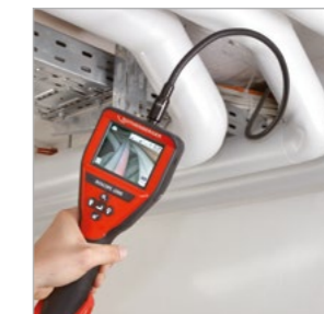
Inspektion von Hohlräumen
