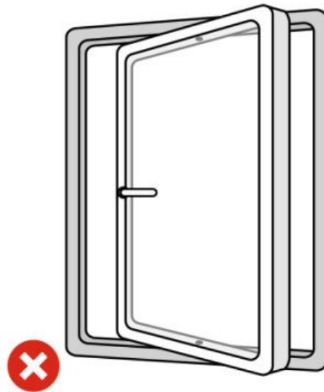
Pivot hinged vertical – Schwingfenster vertikal
