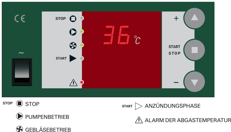
Bild 2. Beschreibung der Kontrolllampen des Reglers
