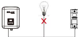
**Nicht zulässiger Anschluss zwischen Last und Wechselrichter**
