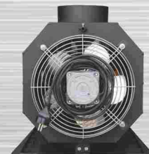
Austauscher mit dem Ventilator (Rückansicht)
