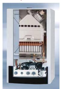
Raumluftunabhängige Gas-Heizwertkombitherme für Niedertemperaturheizung und Warmwasserbereitung mit integriertem Warmwasserwärmetauscher, elektronischer Rohrlängen-Anpassung "ERA", Ventilator stufenlos drehzahlgeregelt, geprüft nach EG-Richtlinien für den Anschluss an Luft-/Abgasschornstein oder Luft-/Abgasführung ins Freie
