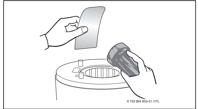
Bild 71 Wärmeblock auf Rückstände prüfen
