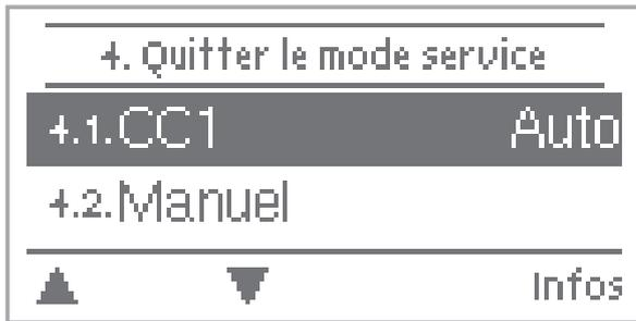
Au menu "4. Modes service", on détermine les modes service pour le circuit de chauffage et l'eau chaude sanitaire .
