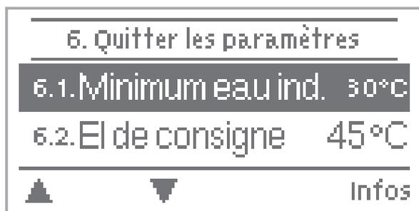
Dans le menu "6. Paramètres EI", on effectue les attitudes fondamentaux nécessaire pour le fonctionnement du régulateur de l'eau chaude sanitaire .
