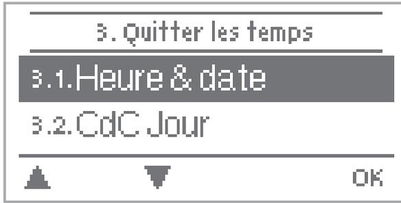
Le menu “3. Temps” permet de régler l’heure, la date, les heures de service pour le circuit de chauffage et l’eau chaude.
