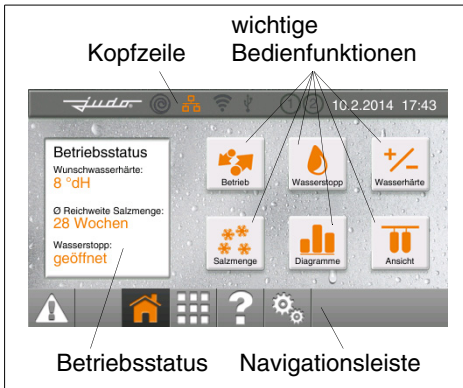
Abb. 11: Home-Ansicht der Enthärtungsanlage
