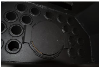
Bild nr. 7 - Anchau aus Feuerstelle Serie B auf Boden des Tauschers mit Blinddeckel.
