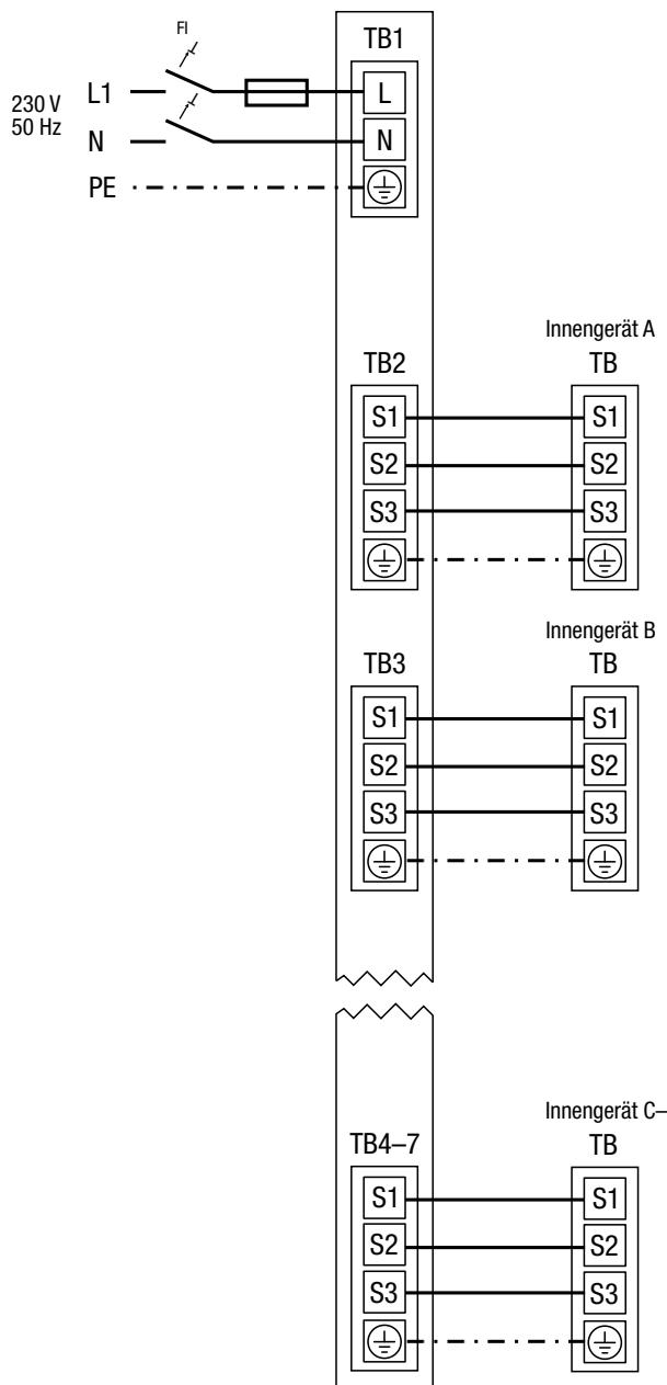
Das Außengerät MXZ wird an die Spannungsversorgung mit L, N und PE an **TB1** angeschlossen.
