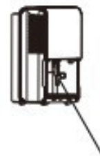
Abb.7 Der Pumpenschlauch tropft.
