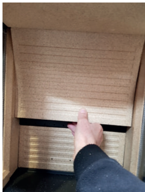
4: Die obere Vermiculite Rückwand wird über den Tertiärluft Kanal bewegt und am Boden der Brennkammer abgelegt.
