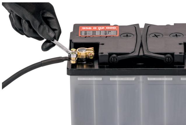
Bringen Sie die Schraube wieder an und drehen Diese mit dem Schraubenschlüssel Größe 8 fest.
