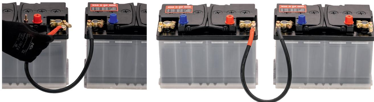
Hier ist es wieder wichtig, dass Sie die Ringkabelschuhe zwischen den Klemmen verschrauben. Hierzu nutzen Sie ein Schraubenschlüssel der Größe 8 um die Klemmen wieder fest zu verschrauben. Die beiden Batterien sind nun fest miteinander verbunden.
