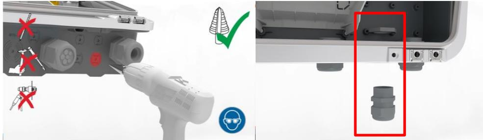
Abbildung 3: Durchbohrung der Grundschaube und eingesetzte PG-Verschraubung an der durchbohrten Stelle
