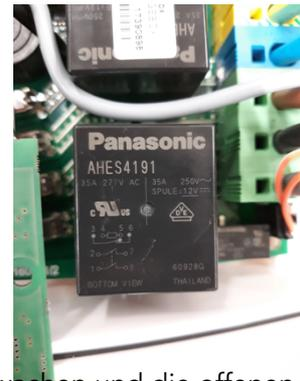
Der Schalter macht es technisch möglich, die Schweißnähte zu überwachen und die offenen und geschlossenen Kontakte ständig zu kontrollieren. Es besteht keine Verbindung zwischen den Phasen und den Lötkontakten.
