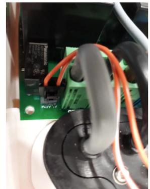
Das Relais sendet ein Ausgangssignal über ein Kabel an den Hauptstromkreisunterbrecher (LS), wenn ein trockener Kontakt erkannt wird, der Kontakt ist normalerweise offen und wird geschlossen, wenn ein festsitzender Kontakt erkannt wird.
