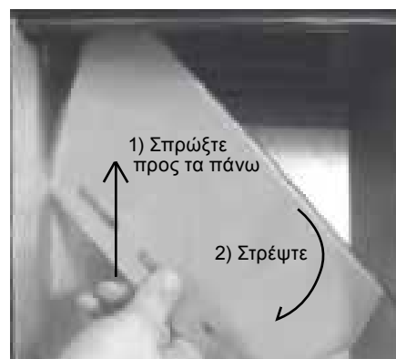
Εικ. 17: αφαίρεση του διαχωριστικού φλόγας
