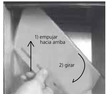
Fig. 17: extracción de la placa cortafuego
