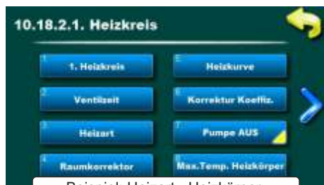
Beispiel: Heizart - Heizkörper
