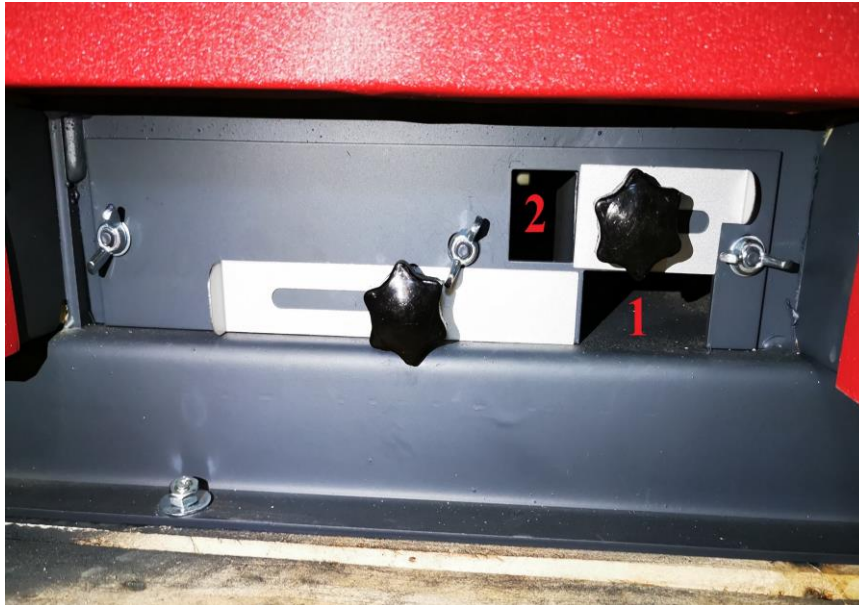
Abbildung 11: Einstellung der Sekundärluftmenge
