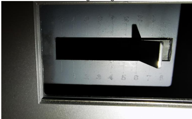
Abbildung 10: Einstellung der Primärluftmenge
