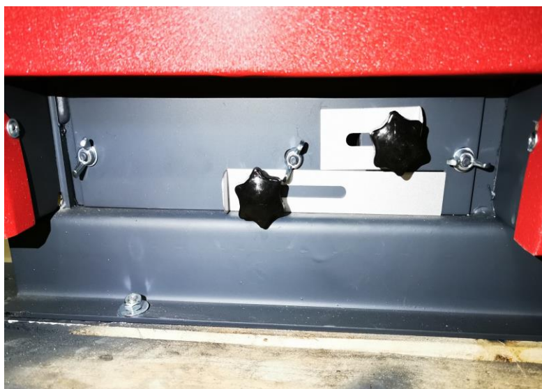
Abbildung 9: Lage der Klappen für die Sekundärluftzufuhr
