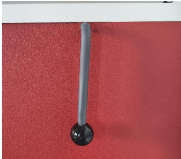
Abbildung 8: Kurzschlussklappenhebel in geschlossener Stellung.
