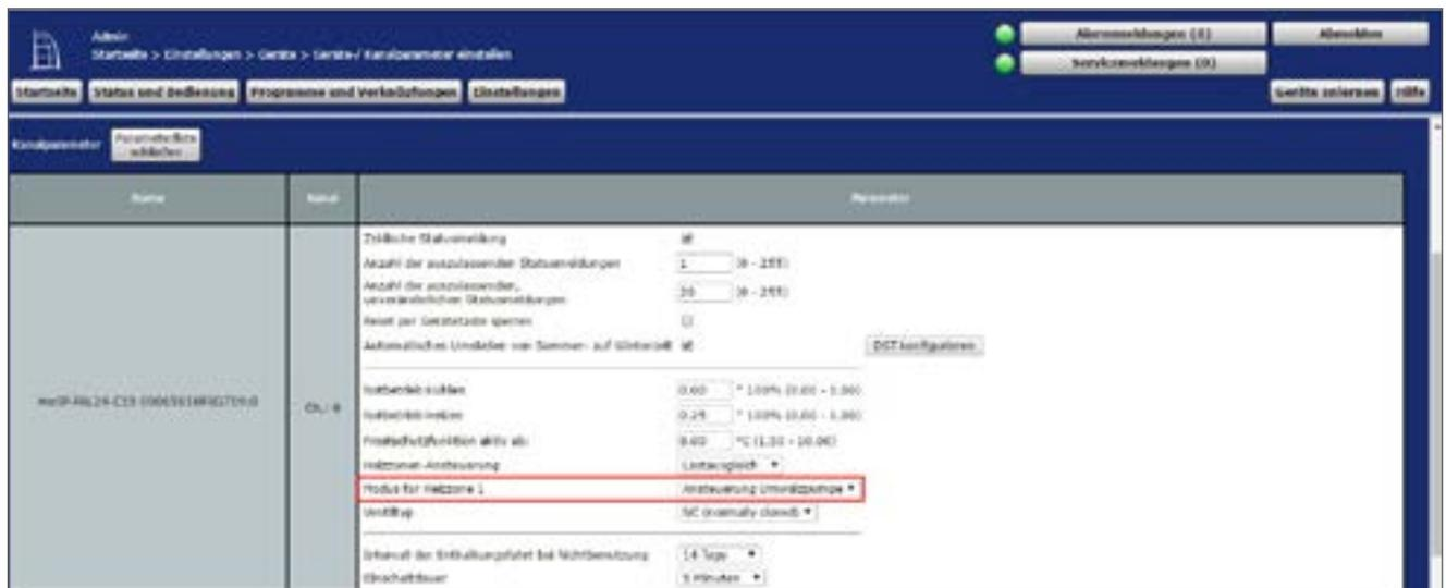
Abbildung 223: Konfiguration Kanalparameter Fußbodenheizungsaktor
