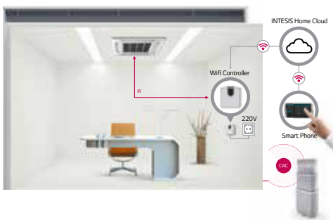
1) Verbindung mit Inneneinheit über Infrarot-Sensor
