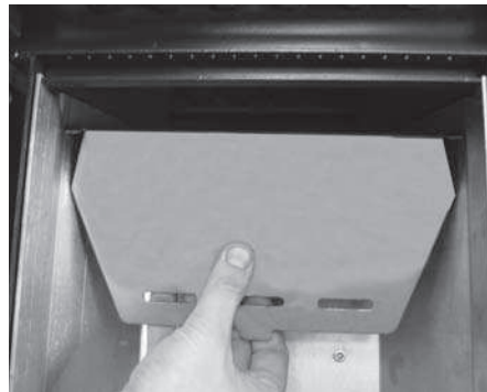
Abb. 16: Rotation der Feuerschutzwand
