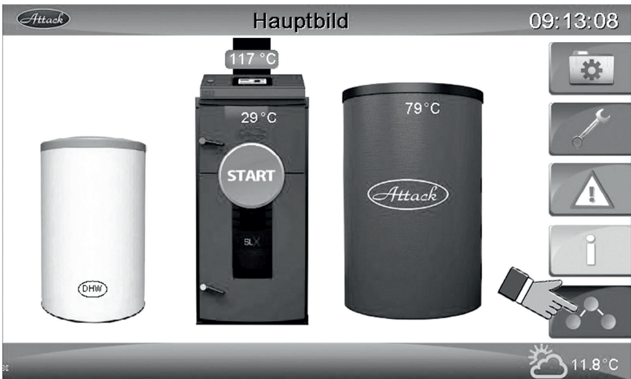
Bild 47. Klick für die Heizkreiseabbildung
