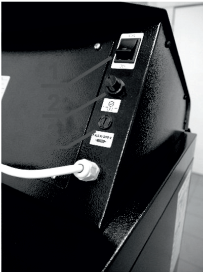
Bild 17. 1 – Hauptschalter, 2 – Havarie Thermostat, 3 – Sicherung (F6,3A)
