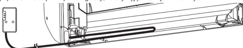
Poprowadzić kabel połączeniowy w przestrzeni z tyłu urządzenia, zgodnie z rysunkiem powyżej.
