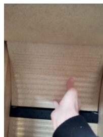
3: L'espace vous permet de soulever la vermiculite arrière supérieure (courbée) au-dessus de la réglette d'arrivée d'air.
