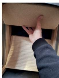
5: Le déflecteur peut maintenant être sorti du foyer.
