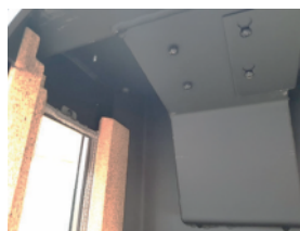
6: Løsne de 4 unbrakoskruene med en 4mm unbrakonøkkel. Se bilde 6a. Metall røyplater 1 og 2 skyves litt tilbake og kan deretter fjernes. Ovnen er nå klar til rengjøring.
