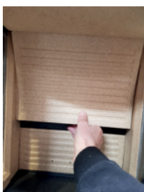
4: La vermiculite courbée peut maintenant être posée sur le fond du poêle.
