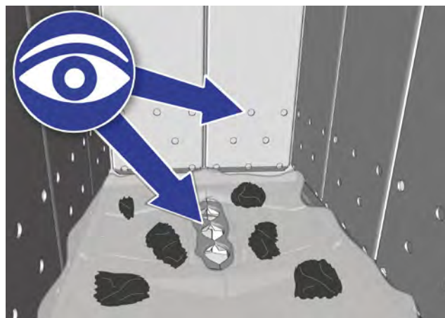
Abb. 6-6: Öffnungen für Primärluft und Durchbrandöffnungen
