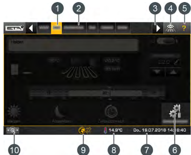
Abb. 5-1: Funktionsblöcke der ETAtouch Regelung
