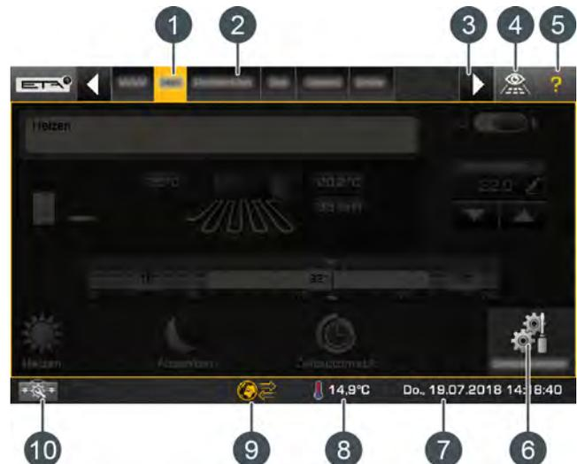
Abb. 5-1: Funktionsblöcke der ETAtouch Regelung
