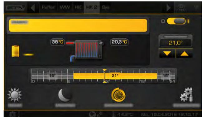
Abb. 5-65: Übersicht mit Heizkörper
