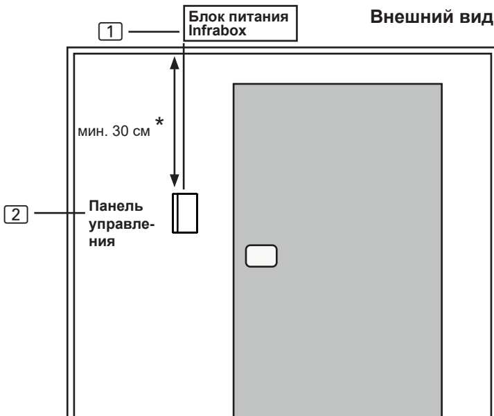
Рис. 2. Расположение панели управления
