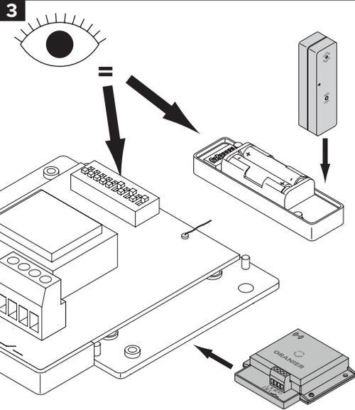
Die Codierung bei Funksender und Funkempfänger muss identisch sein. Falls zusätzlich noch ein BL220DD verbaut ist, bitte die Einstellung der Codierung entsprechend der Bedienungsanleitung anpassen.
