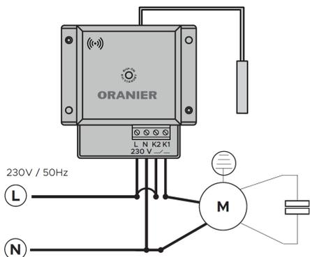
Bei einigen Abluftanlagen hat der Hersteller bereits einen Anschluss für den potentialfreien Kontakt vorbereitet. Dieser wird zum Anschluss an Kontakte K1 und K2 verwendet.
