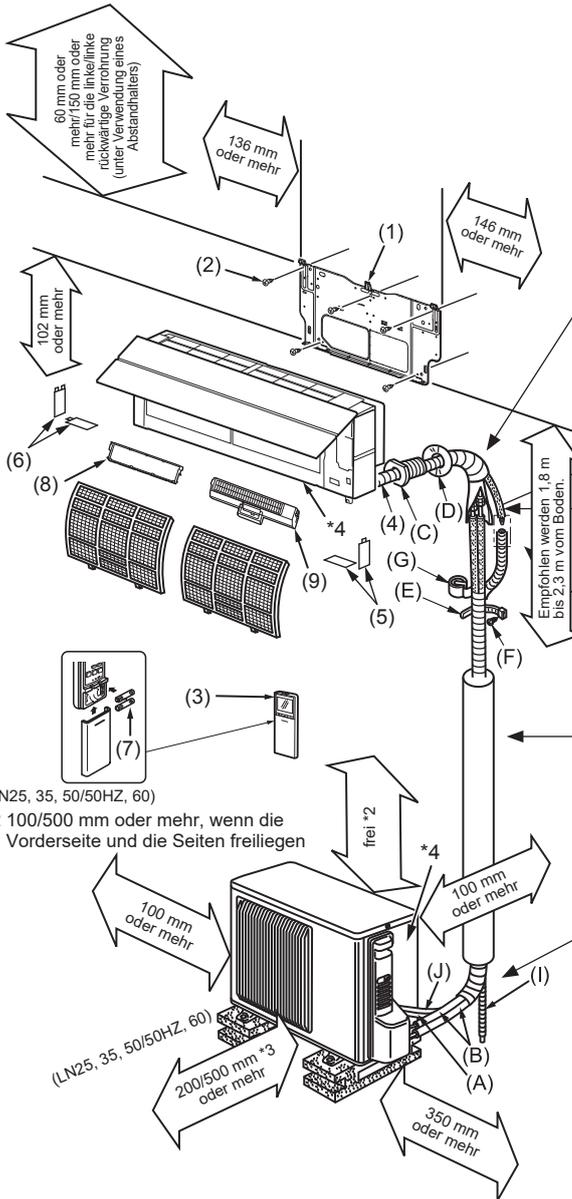
Verwenden Sie unbedingt die Wanddurchbruchhülse (C), um einen Kontakt des Innen-/Außengerät-Verbindungskabels (A) mit Metallteilen in der Wand sowie Beschädigungen durch Ratten bei Hohlwänden zu verhindern.
