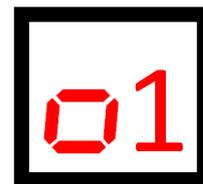
Nach der Wahlbestätigung *des manuellen Modus* mit der MENU-Taste leuchtet die Diode *praca ręczna*. In dieser Betriebsart wird die Pumpe mit der PLUS-Taste eingeschaltet und mit der MINUS-Taste ausgeschaltet. In dieser Funktion kann man überprüfen, ob die angeschlossene Pumpe betriebsbereit ist.
