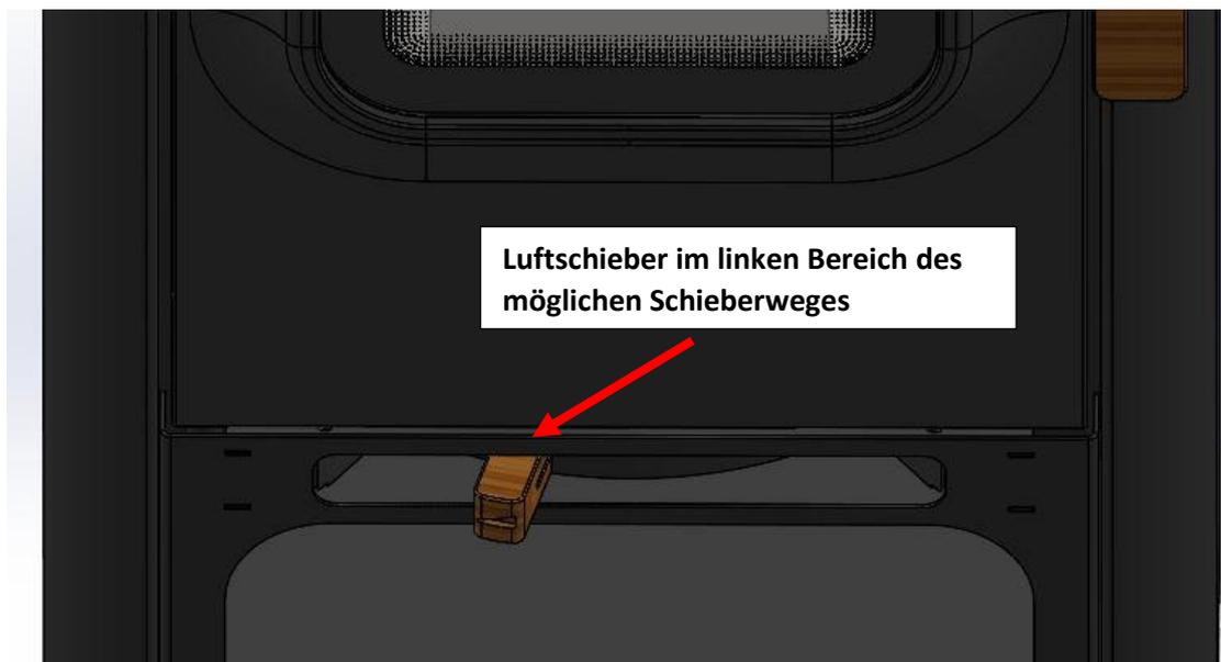
**Zuluft geschlossen:** Wenn der Ofen nicht in Betrieb ist, wird durch die geschlossene Schieberstellung verhindert, dass warme Luft aus dem Wohnraum über den Ofen und Kamin ins Freie gesaugt wird.
