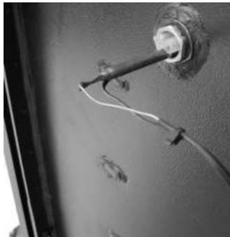
**Wassertemperatursonde:** wenn die Wassertemperatur die Sperrtemperatur (100°C) erreicht, unterbricht die Sonde die Pelletzufuhr.
