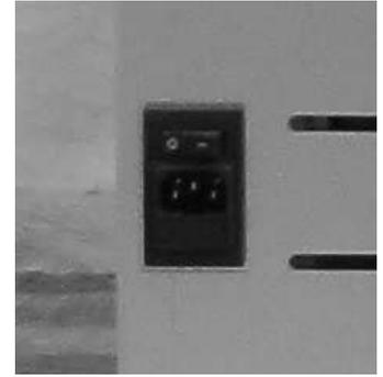
**Elektrische Sicherheit:** der Wasserführende Pelletofen ist gegen starke Spannungsschwankungen (zum Beispiel Blitze) durch eine Generalsicherung von 4 A, die sich am Bedienfeld auf der Rückseite des Wasserführende Pelletofens in der Nähe des Netzkabels befindet, geschützt. Weitere Sicherungen für den Schutz der Elektronikarten sind ebenfalls vorhanden.
