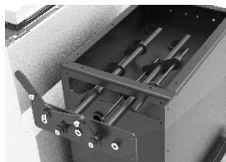
Nun ist das Oberteil an dem Wärmetauscher frei, so dass eine einwandfreie Reinigung möglich ist.
