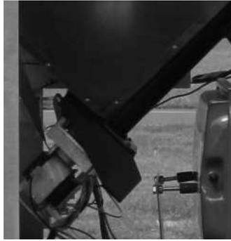
**Getriebemotor:** wenn der getriebemotor anhält, läuft der Wasserführende Pelletofen weiter, bis die Flamme aufgrund fehlendem Brennmaterial ausgeht und bis das Mindestniveau an Abkühlung erreicht wurde.
