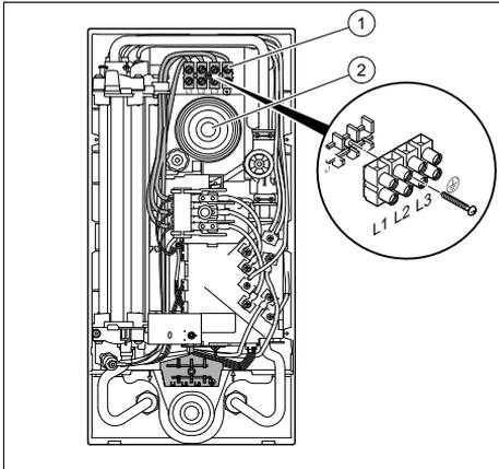
1. Führen Sie das Anschlusskabel durch die obere Kabeldurchführung (2).
