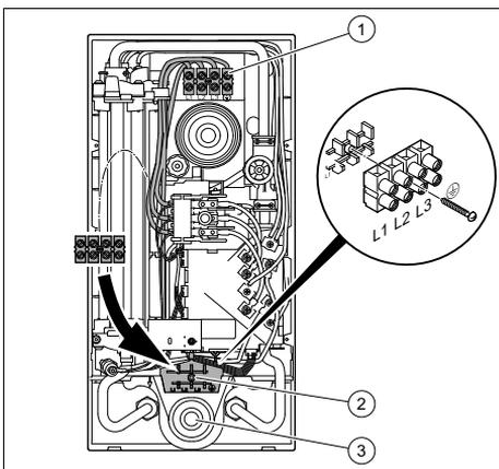
1. Führen Sie das Anschlusskabel durch die untere Kabeldurchführung (3).
