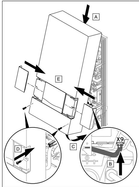
Wenn das Kabel für den Temperaturwähler nicht auf die Elektronik gesteckt ist, dann kann die Elektronik die Leistung nicht regulieren. Die Auslauftemperatur beträgt 30 °C.
