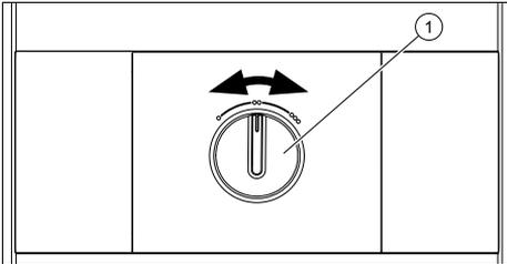
Mit dem Temperaturwähler (1) können Sie eine Auslaufterperatur zwischen 35 °C (1. Stufe, Linksanschlag), 45 °C (2. Stufe) und 55 °C (3. Stufe, Rechtsanschlag) einstellen.
