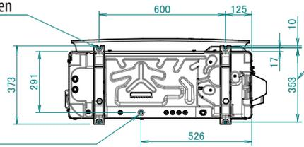
Abstand der Bohrungen für Ankerbolzen
